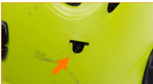
Otsavalaisimen kiinnike puuttuu, kiinnityskohta pääpannalle ja sen tukihihnalle heikentynyt.
