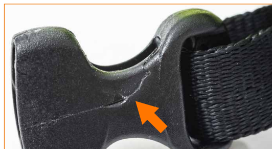
Boucle d'attache de la jugulaire modèle femme fissurée.
