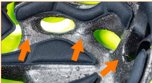
Sisäinen polystyreenikuori rikki useasta kohdasta.
