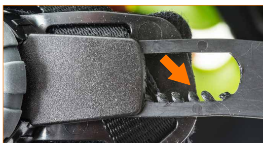
Sistema de regulación del contorno de cabeza que se desajusta sin mantener su posición, algunos dientes dañados.
