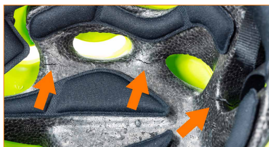
Carcasa interior en poliestireno rota en varios puntos.
