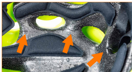
Coque interne en polystyrène fendue en plusieurs endroits.
