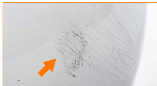
Visière avec présence d'entailles et d'abrasions.
