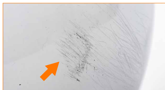
Pantalla de protección con rayaduras y abrasiones.
