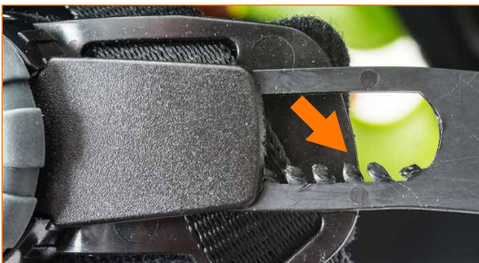
Das Einstellsystem des Kopfband behält die Position nicht bei, es gibt beschädigte Zähne.
