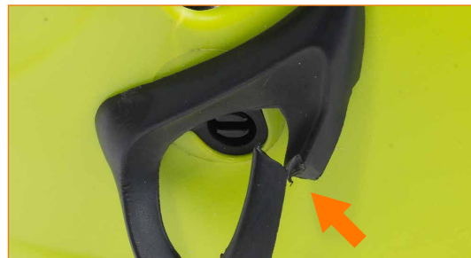
Rikkoutunut otsavalaisimen kiinnike.
