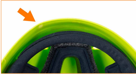
Yleinen kuoren muodonmuutos; materiaalissa näkyy merkkejä heikentymisestä.
