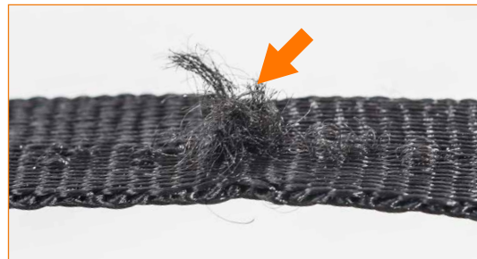
Riemen mit Austritt der Nahtfäden.
