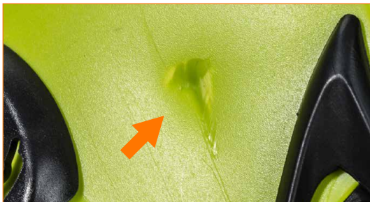
Terävästä iskusta vaurioitunut kuori.
