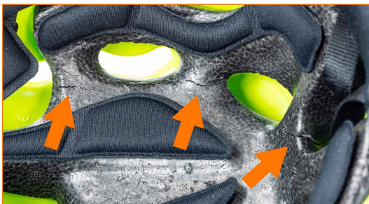
Innere Helmschale mit kaputtem Styropor an verschiedenen Stellen.
