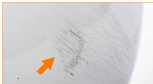
Visiera con presenza di incisioni e abrasioni.
