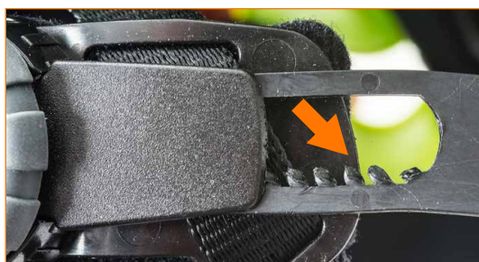
Sistema di regolazione della fascia girotesta che non mantiene la posizione, presenza di denti danneggiati.
