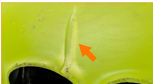
Verformung nach Aufschlag an einem bestimmten Helmschalenpunkt.
