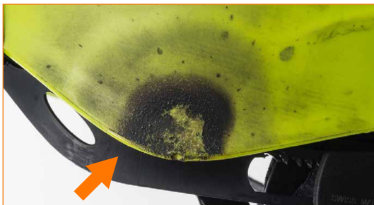
Kuori, jossa on palojälkiä.
