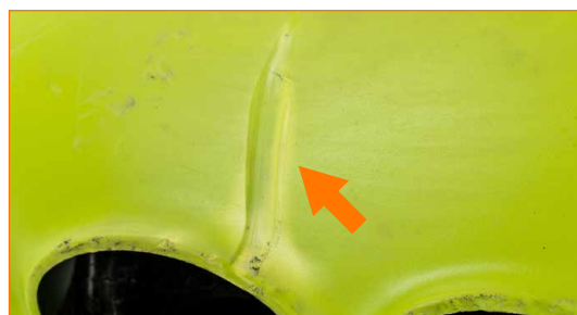
Déformation due à un impact concentrée sur un endroit précis de la calotte.
