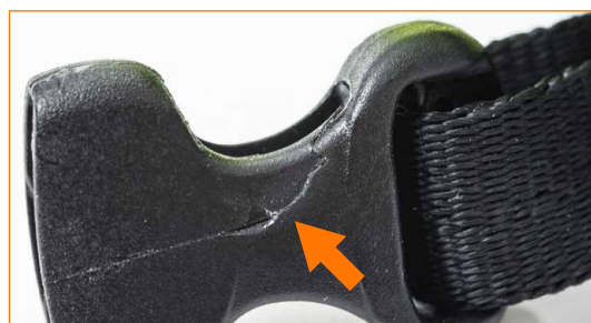
Hembra de la hebilla de cierre con fisuras.
