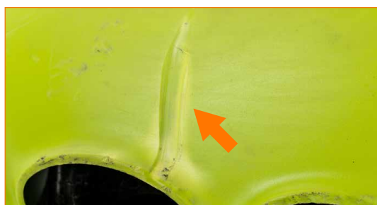
Deformación por impacto concentrada en un punto de la carcasa.
