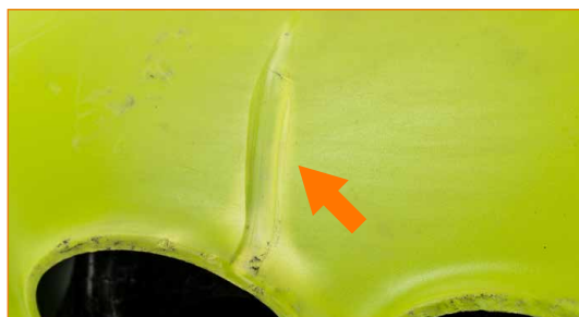
Deformazione da impatto concentrata in un punto della calotta.
