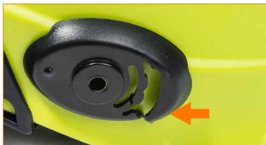
Support pour visière cassé.
