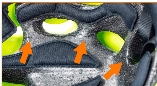
Calotta interna in polistirolo rotta in diversi punti.
