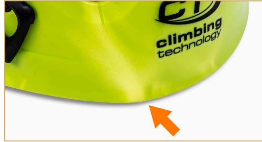
Yleinen kuoren muodonmuutos; materiaalissa näkyy merkkejä heikentymisestä.
