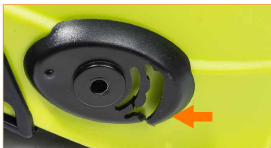
Soporte pantalla de protección roto. 🔧 Reemplazar con la correspondiente pieza de repuesto.
