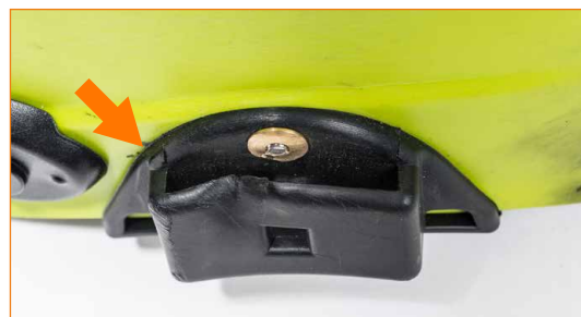
Kuulonsuojainten kiinnityspiste on käyttökelvoton. Vaihda sopivaan varaosaan.
