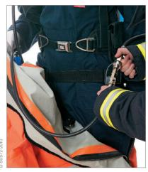
Verbindung der Druckluftschlauchleitung mit dem Pressluftatmer im Anzuginneren
